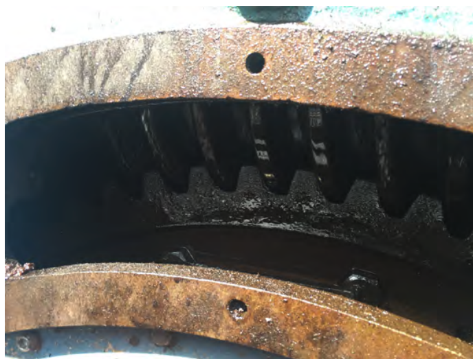
Imagem 2 – detalhe do conjunto: roda dentada e rosca sem fim de acionamento TAG 20-3212-43
